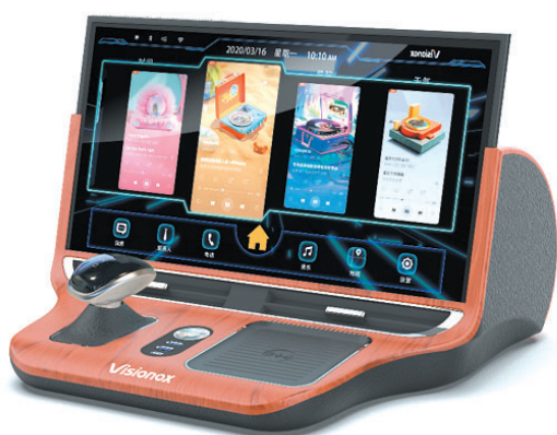
全球首款 14.2 英寸车载滑移卷曲 AMOLED 中控屏
