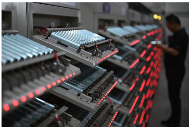
7月19日,在安徽巡鹰新能源集团车间,回收的新能源汽车动力电池在分容检测
