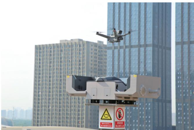
工作,飞行过程中可实时回传数据至系统后台,后台同步进行隐患诊断。采取无人机巡视后,过去需要半天以上的“精益化”配电网线路巡视过程大幅度缩短至1小时内,减轻了一线人员工作强度和压力,提升工作效率和安全性。
