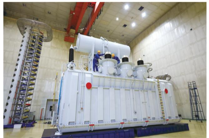
2月27日,在合肥庐阳经济开发区天威保变(合肥)变压器有限公司车间,技术人员正在对即将送往合肥皖能燃气发电有限责任公司的2组220KV62万KVA变压器进行技术调试。据悉,该公司通过科技创新,利用电磁仿真技术,有效控制了超大容量电力变压器漏磁引起的金属结构件附加损耗,避免了产品局部过热问题,产品研制一次成功。
