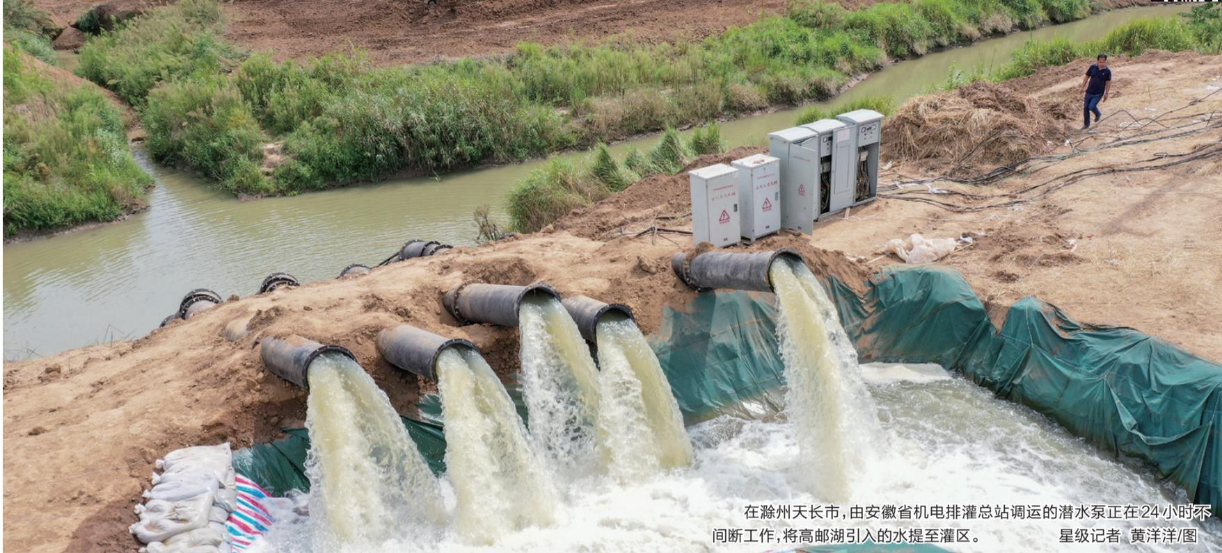
在滁州天长市,由安徽省机电排灌总站调运的潜水泵正在24小时不间断工作,将高邮湖引入的水提至灌区。
