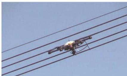
俄罗斯联邦知识产权局网站近日公布的文件显示,俄罗斯国防部下属的秋明高等军事工程指挥学校的专家,研制出了可以用输电线充电的无人机,从而大幅延长了小型无人机的飞行时间。这项发明简称,备案的无人机是多旋翼飞行器,其底部安装了电缆钳(环状导磁体),用它来夹住输电线进行充电。
