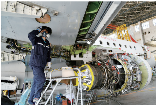
一位工程师在工作中检修机翼油箱。 新华社发 朱峥/摄
