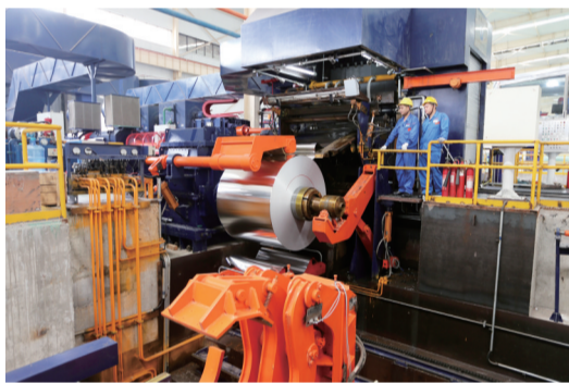
华中天力年产20吨高精铝板带生产线
