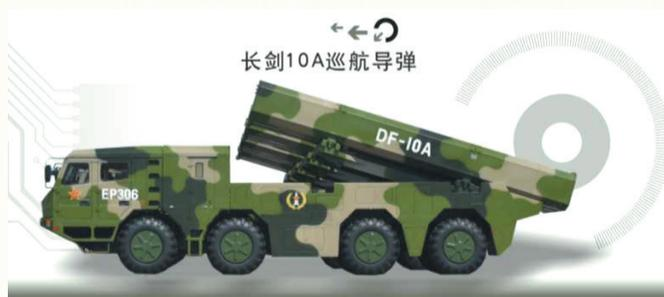
长剑10A巡航导弹构成常规导弹第三方阵。它具备超低空隐身突防、多模式复合制导、多角度连续攻击能力,命中精度高、杀伤威力大,是我军精确打击、克敌制胜的主战装备。
