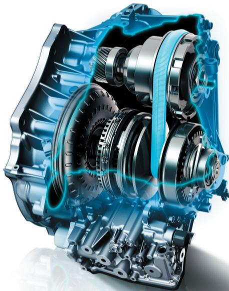
同其他三款变速器相比，CVT在结构上可谓自成一派：不同于其他变速器通过齿轮进行变速，CVT采用传动带和可变槽宽的棘轮进行动力传递，从而提供平稳和“无级”的速比转换。由于其独有的“带状”式结构，CVT的变速比不是间断的点，而是一系列连续的值，从而实现了良好的经济性、动力性和驾驶平顺性。
