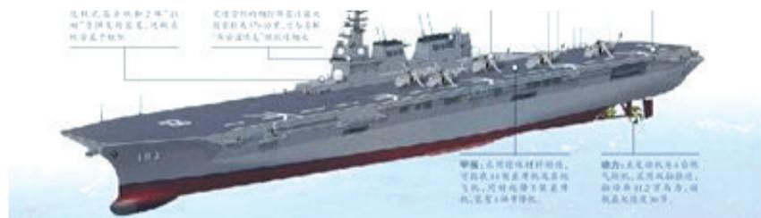
1945年8月6日,日本广岛遭到美军原子弹轰炸,并最终导致日本投降。60多年过去了,日本海上自卫队新一代直升机驱逐舰22DDH将于8月6日下水。据日本媒体报道,22DDH满载排水量达2.7万吨,其飞行甲板、自身防御系统经过全新升级,最多可搭载14架直升机,将来还有可能搭载F-35B型隐形战机。22DDH所有这些特征,都无限接近现代航母的特征。可见,22DDH就是一艘披着驱逐舰外衣的航母。
