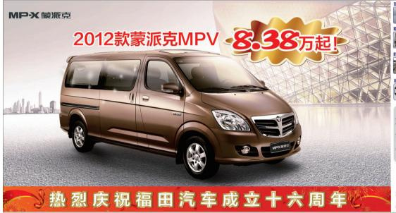
采用4Gi系列汽油动力及康明斯ISF系列2.8 T 乘用型柴油动力,功率最高达95-125 k W,降低油耗8%,实现高效商务。
