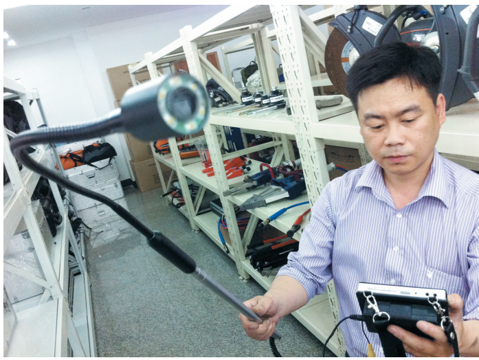
省地震局的应急救援工作者向记者演示视频生命探测仪的使用
