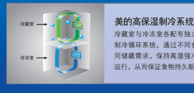
美的高保湿制冷系统 冷藏室与冷冻室各配有独立的风冷制冷循环系统,通过不同食物的不同储藏需求,保持高湿强冷的联动运行,从而保证食物持久新鲜。
