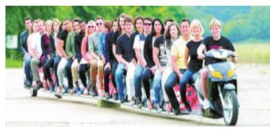
英国管道工科林·弗兹耗时一个月,把排量125毫升轻便摩托车改造成长22米的超长摩托车。他向吉尼斯世界纪录认证机构递交申请,申请“世界最长摩托车”纪录。弗兹现年31岁,家住林肯郡斯坦福。他耗时一个月,花费3000英镑(约合4800美元),以排量125毫升的摩托车为基础,用铝制框架延长车身,继而把三部分拼接在一起,造出一辆超长摩托车,22米车身接近一个标准网球场的长度,最多能供25人同时乘坐。现有“世界最长摩托车”纪录为1403米,由弗兹2008年10月创下。
