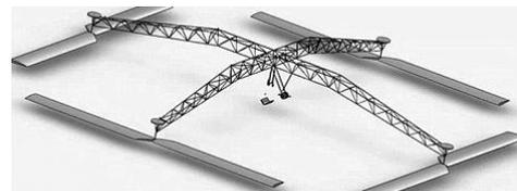
长18.29米,每个水平旋翼的直径约为12.8米,置于地面时约占一个标准足球场面积的三分之一,但重量只有63.5千克。
