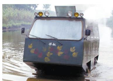
11 月 15 日,河北退伍老兵高尚会展示自己手工造出的水陆两栖车。据高尚会介绍,整车由 11 种车部件组成,车上 100 多种零件都是自己造的,车舱能装备一个班的兵力。该车以四轮驱动,既能爬山又能涉水,陆地时速为 70 公里,水上时速达 10 公里。因其越野性敢与悍马车媲美,研制者称其为“悍舰”。
