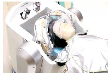
3 洗头机器人 本机采用机械手技术,带有16个机电一体化的魔法手指用于冲洗和清洁头发。它还能记忆每个用户的个人数据,如头部形状和按摩喜好等。
